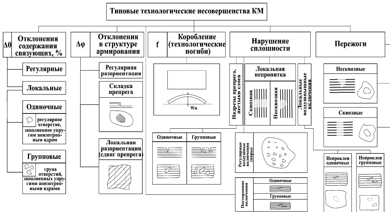
Рис. 1. Схема типовых технологических несовершенств полимерных КМ
