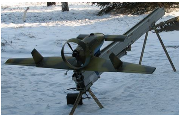
Рис. 1. Серийный образец пневматической катапульты с БЛА «Ремез-3У» на стартовой позиции
