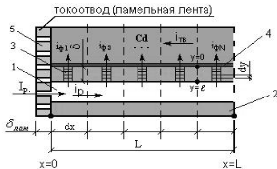
Рис. 1. Схематическое изображение поры кадмиевого электрода.
