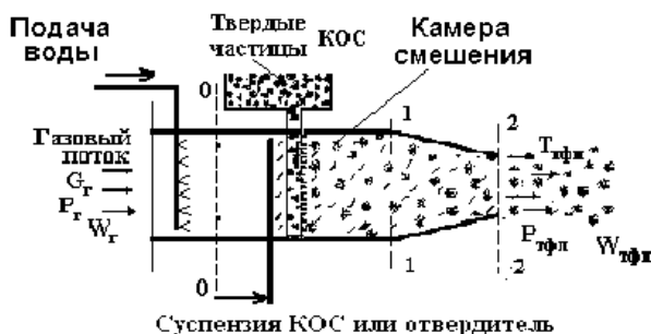
Рис. 2. Схема разгонного многофазного устройства
