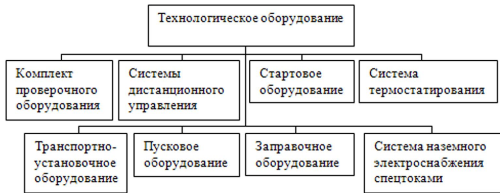
Рис. 1. Состав технологического оборудования стартового комплекса
