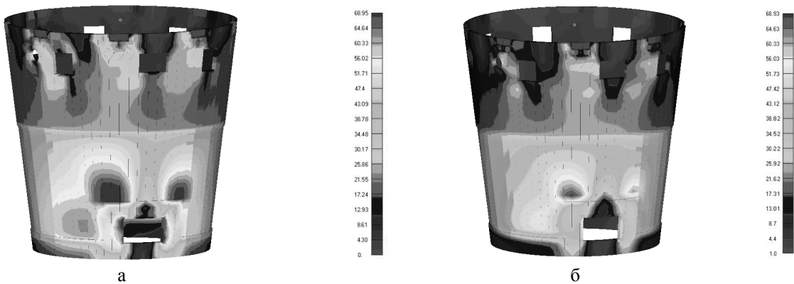
Рис. 4. Распределение максимальных расчетных сдвиговых напряжений в обшивках МСО из ПКМ для случая нагружения «Полет РН на АУТ» при нагружении испытательными нагрузками:
