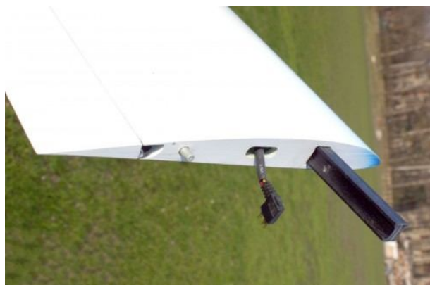
Рис. 5. Соединение центроплана крыла с консолями
