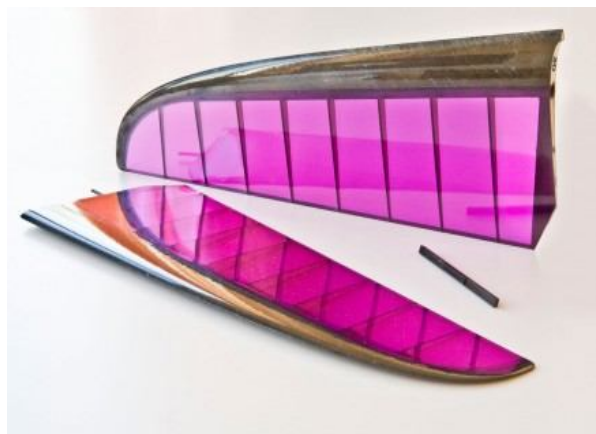
Рис. 11. Стабилизатор Р/У планера МАХА
