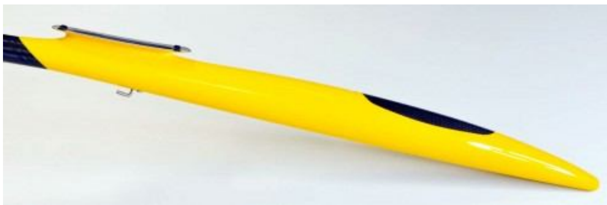
Рис. 7. Носовая часть фюзеляжа Р/У планера МАХА
