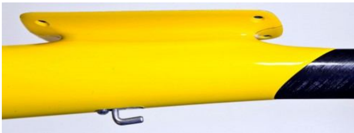
Рис. 8. Узел крепления крыла Р/У планера МАХА
