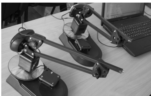
Рис. 18. Лабораторный стенд для изучения принципов радионавигации
