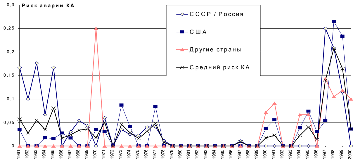
Рис. 4. Значения рисков аварии космических аппаратов
