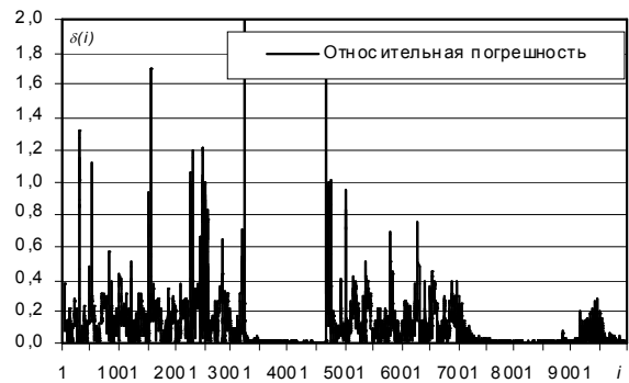
Рис. 9. Относительная погрешность измерений после обработки предлагаемым медианно-линейным ЛАФ
