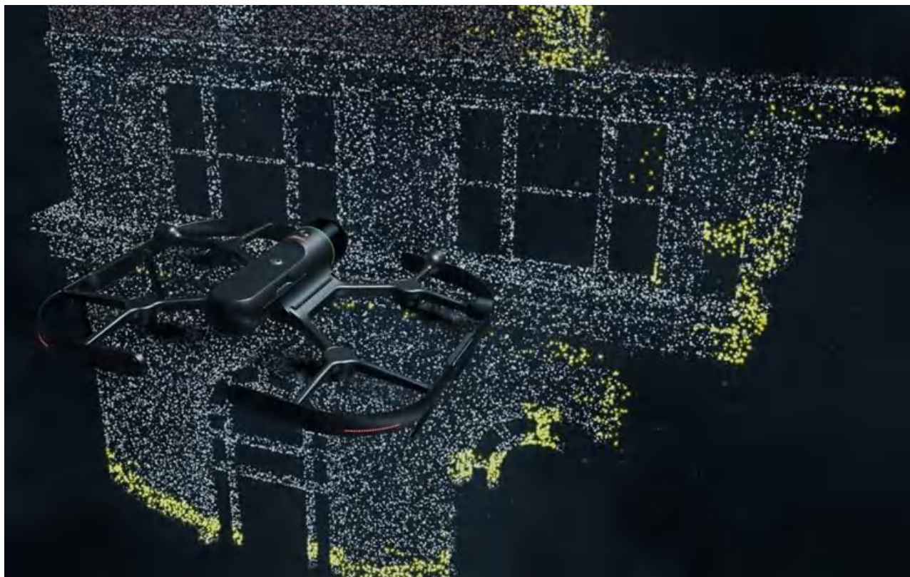
Рисунок 2.7 – візуалізація роботи БПЛА з RTK модулем та LIDAR
