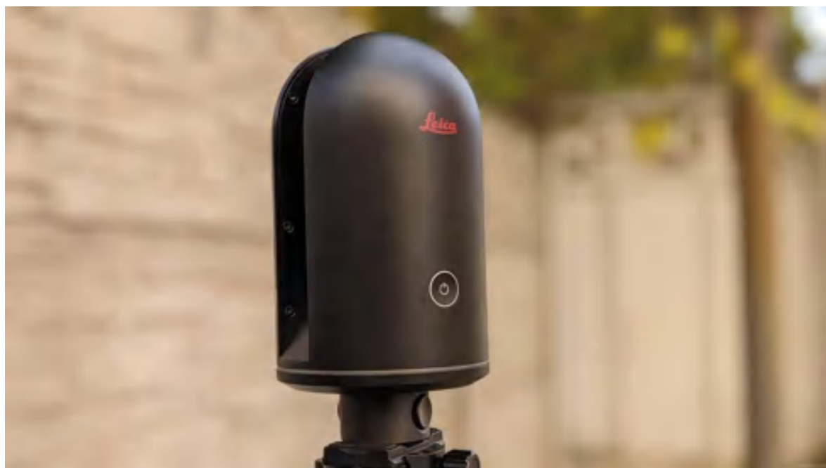
Рисунок 2.11 – Виконання зйомки за допомогою лазерного сканера Leica BLK 360 G1
