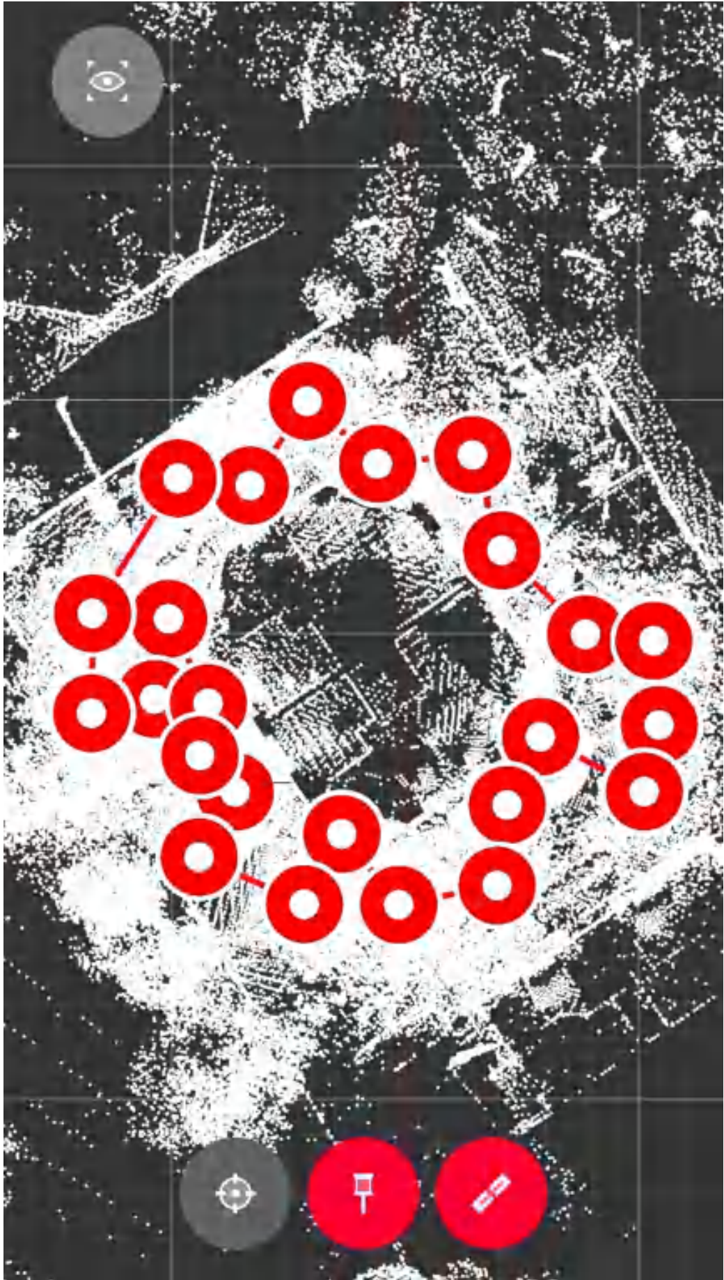
Рисунок 3.25 – Місцерозташування станцій сканування під час проведення геодезичних вишукувань оцінки руйнувань приватного будинку
