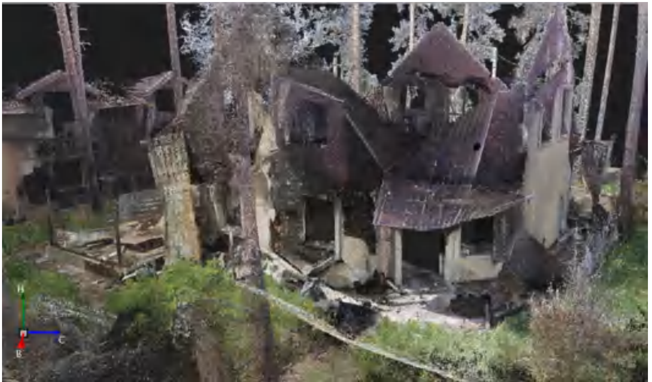
Рис. 3.30 – Результати лазерного сканування у вигляді хмари точок
