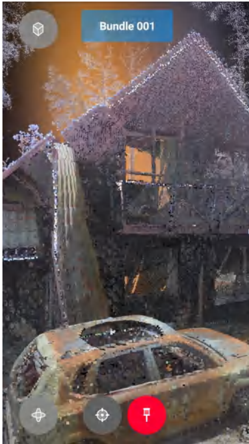
Рисунок 3.26 – Контроль виконання лазерного сканування
