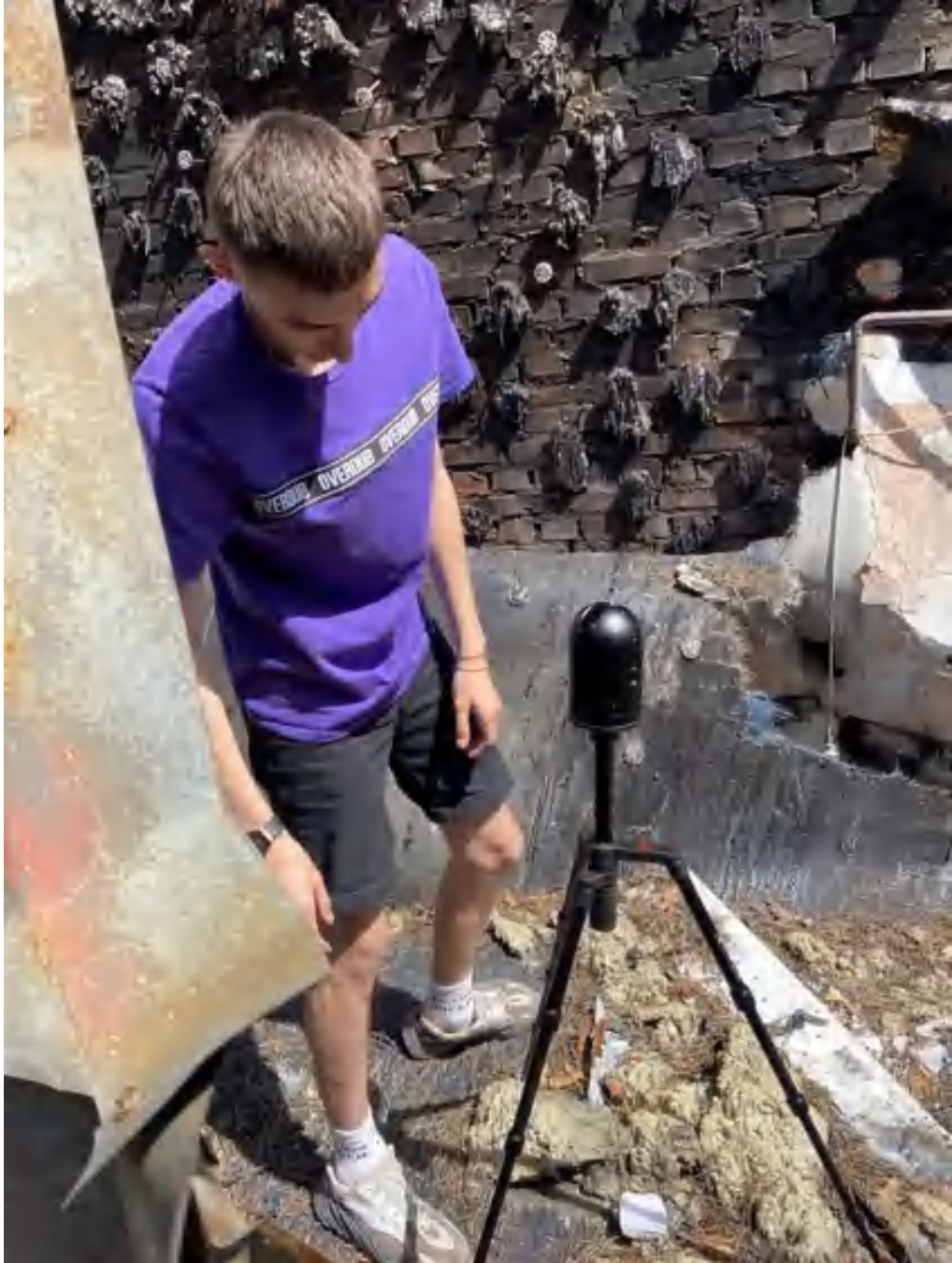
Рисунок 3.23 –Виставлення сканера у робоче положення
