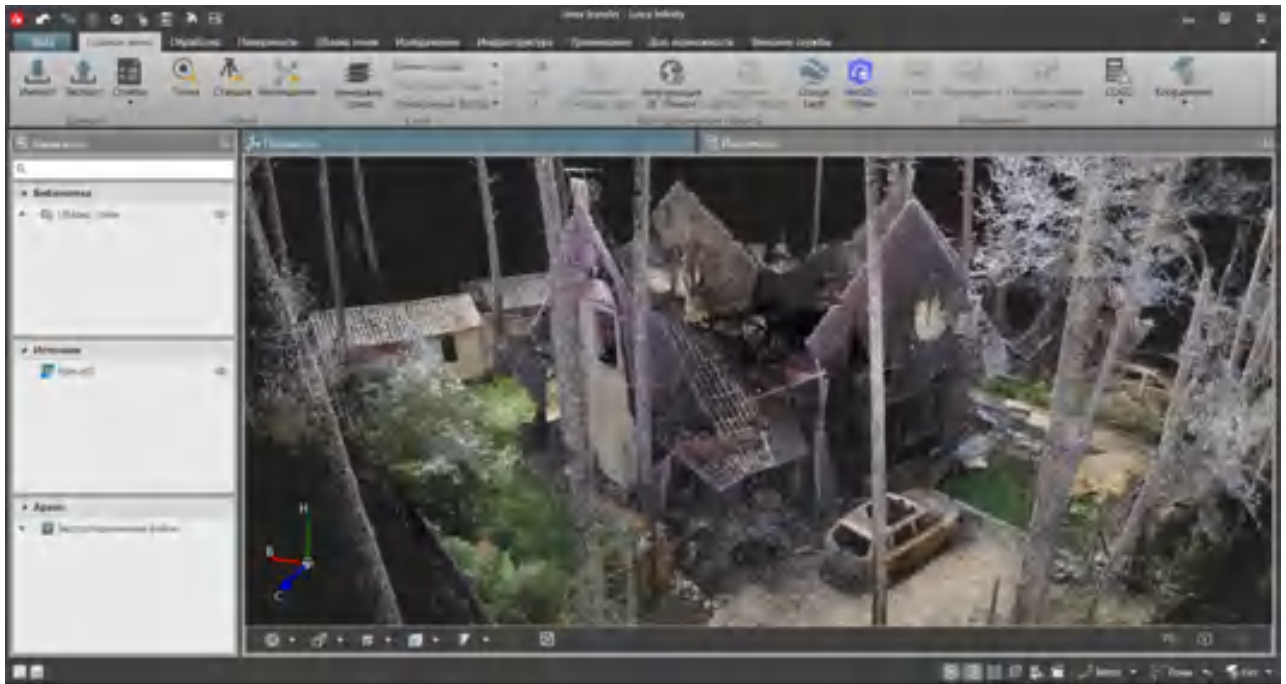
Рисунок 3.27 – Імпортована хмара точок до Leica Infinity
