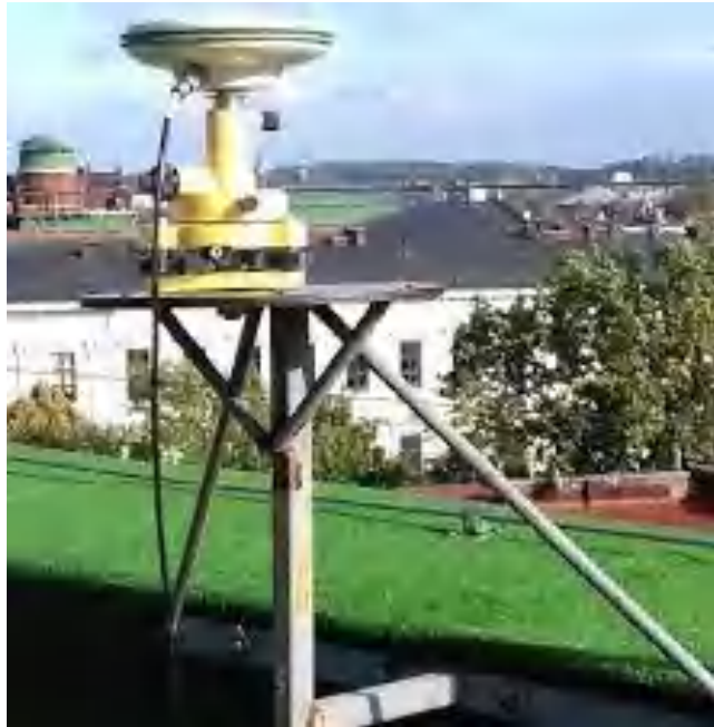
Рисунок 2.29 - Приклад роботи GNSS-приймача у статичному режимі на пункті примусового центрування (м. Львів, мережа Geoterrace)
