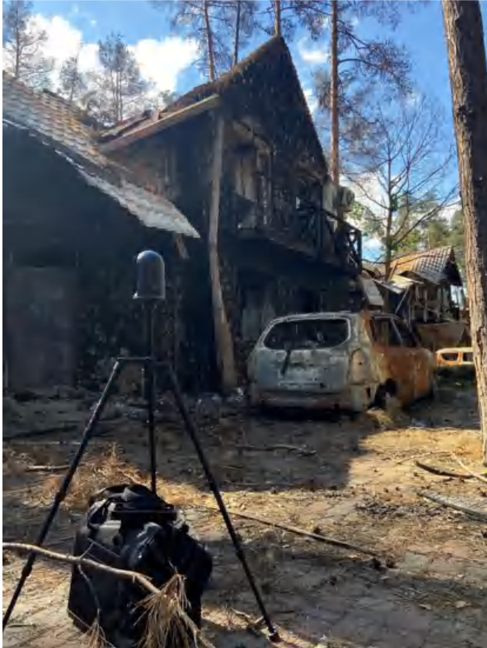
Рисунок 3.24 – Робота сканера на зруйнованому об'єкті
