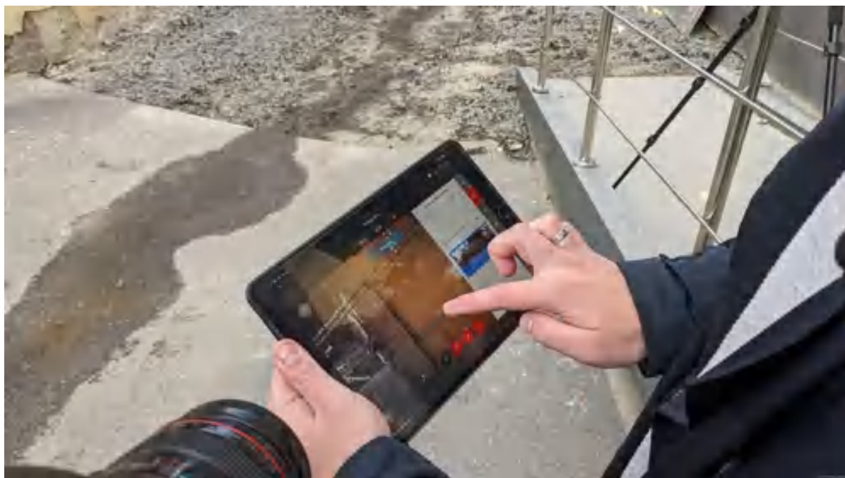
Рисунок 2.10 – Сканування за допомогою програмного забезпечення Leica Cyclone Field 360
