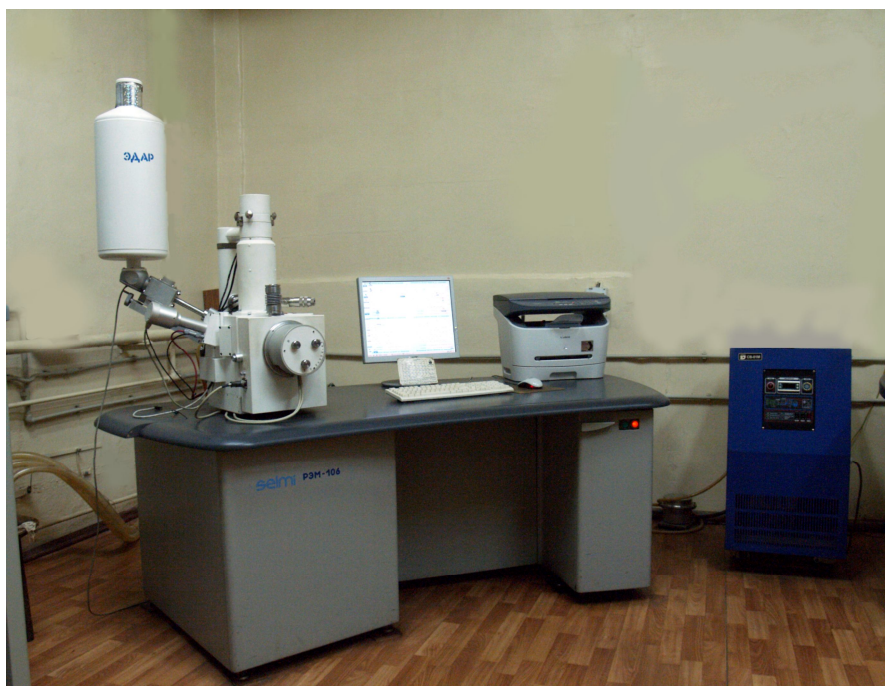
Рисунок 3.14 – Электронный микроскоп РЭМ - 106 для исследования образцов
