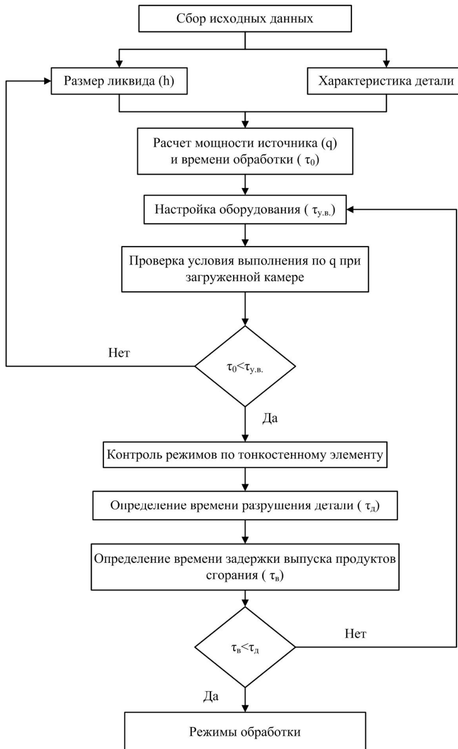
Рисунок 2.11 – Алгоритм выбора режимов термоимпульсной обработки
