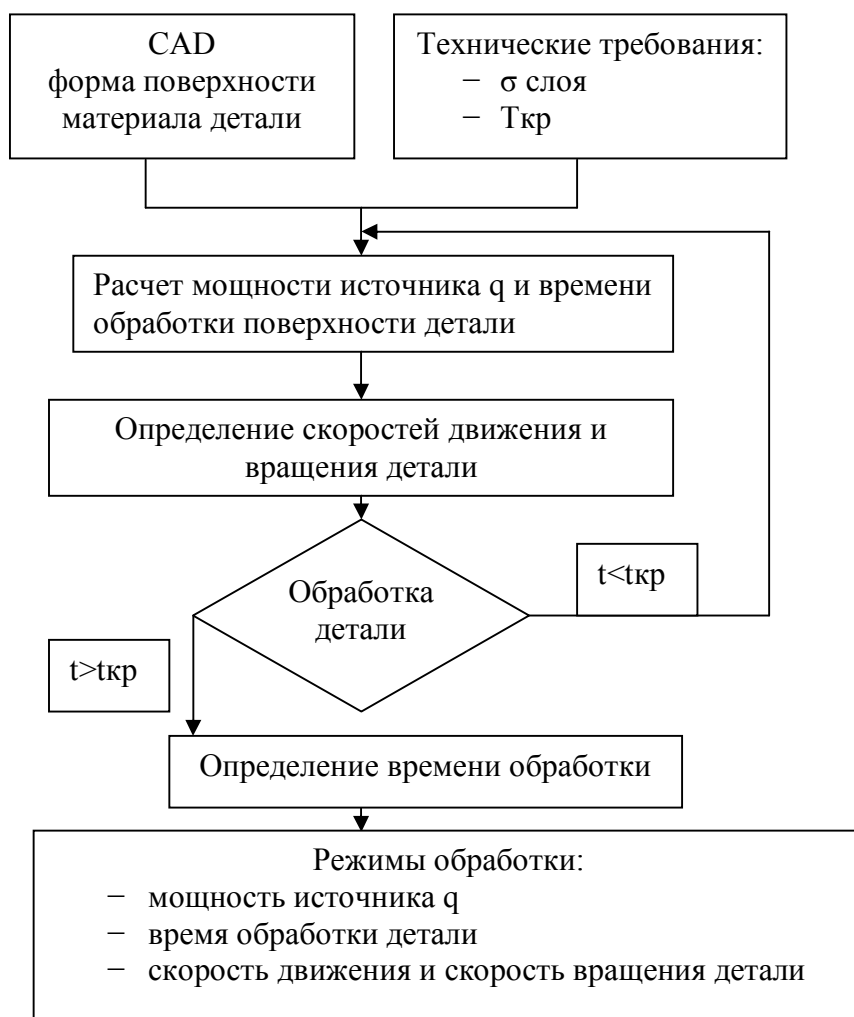
Рисунок 3.9 – Алгоритм выбора параметров процесса очистки детали источником ионов
