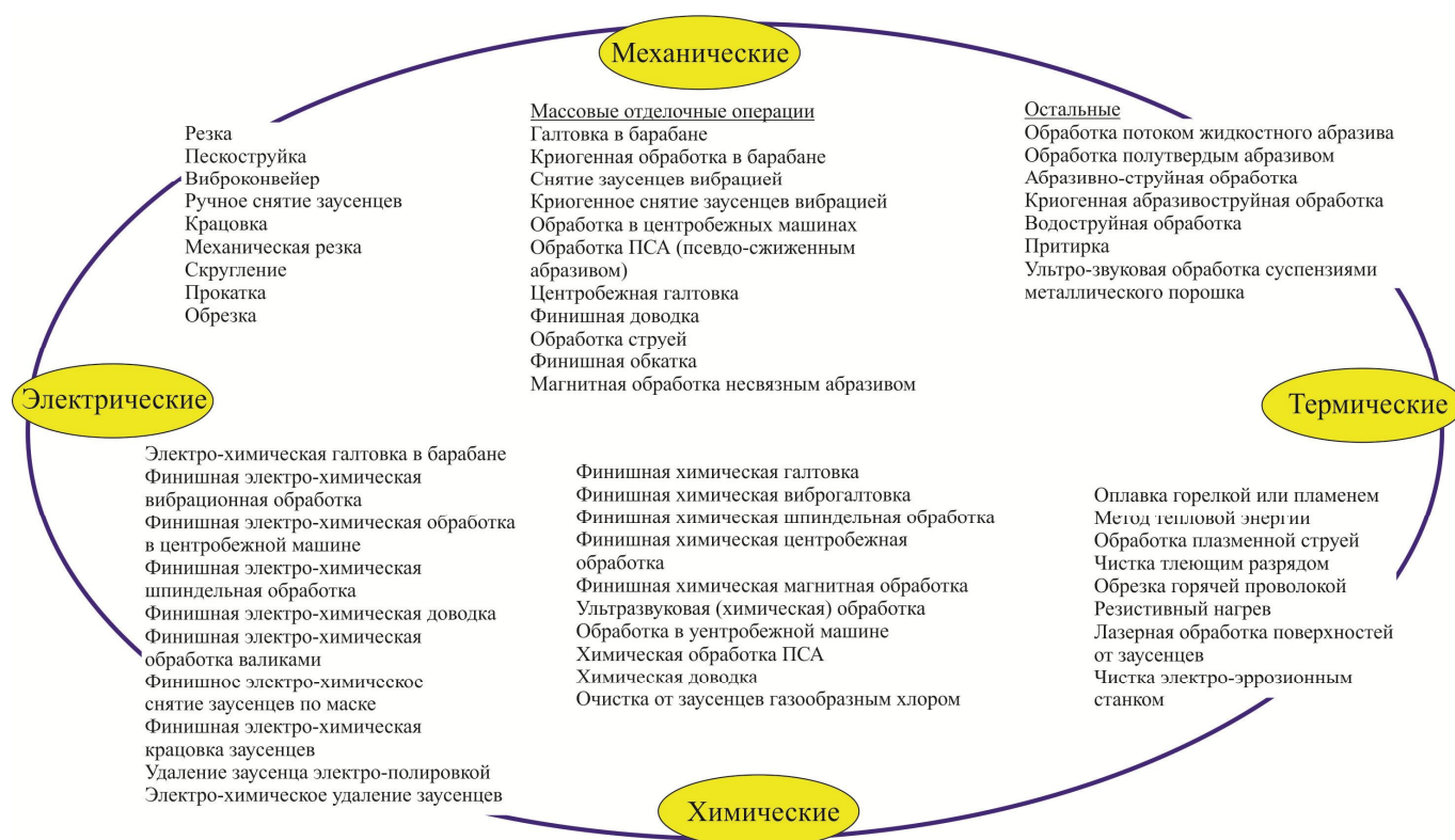
Рисунок 1.16 – Классификация методов финишной обработки
