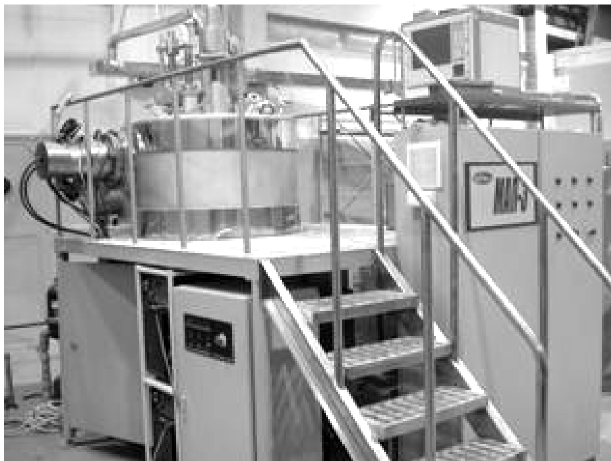
Рисунок 3.26 – Установка типа МАИ для ионного травления поверхности обрабатываемого изделия
