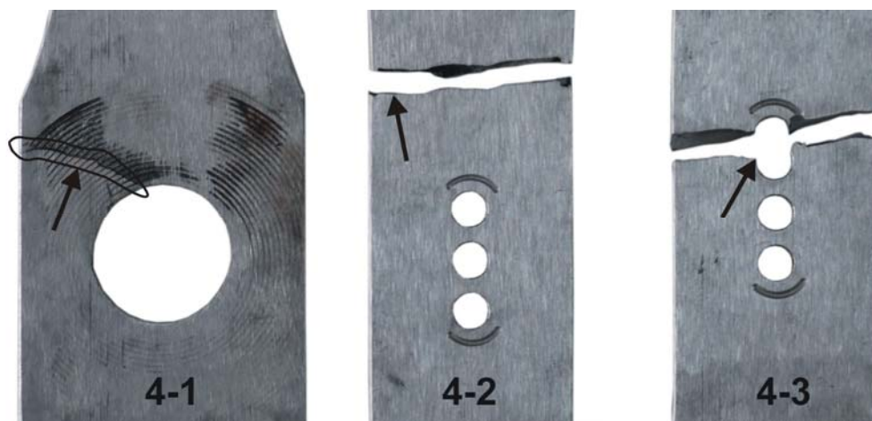
Рис. 11. Характер усталостного разрушения образцов пластин с тремя отверстиями, упрочнённых в зоне отверстий последовательным применением дорнования с относительным натягом 2% и барьерного обжатия в виде лунок сегментной конфигурации из прессованного профиля (материал Д16Т)
