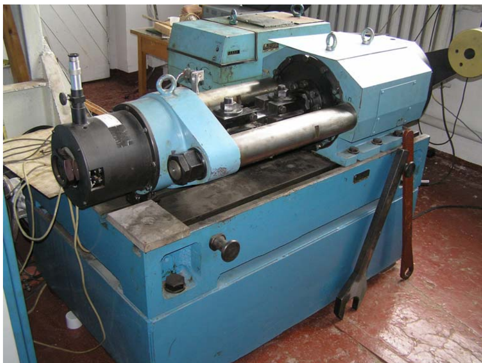
Рис. 7. Машина для проведения усталостных испытаний УММ-02
