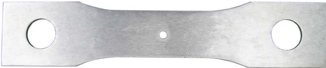
Рис. 4. Пластина с одним неупрочненным отверстием
