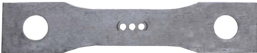
Рис. 6. Пластина с тремя отверстиями, упрочненная в зоне отверстий
