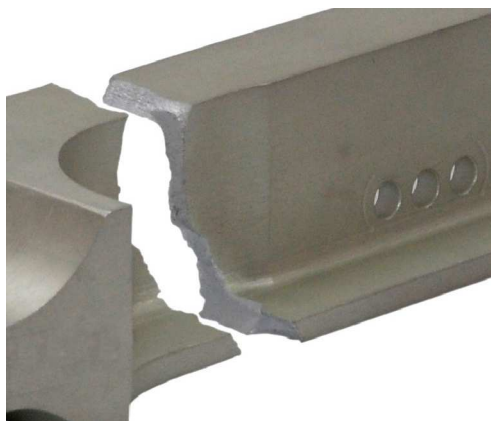
Рис. 15. Характер усталостного разрушения конструктивно-подобного образца стрингера (материал Д16Т), обработанного в зоне отверстий последовательным применением дорнования и барьерного обжата на уровне нагружения:
