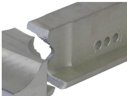
Рис. 14. Характер усталостного разрушения конструктивно-подобного образца стрингера, обработанного в зоне отверстий последовательным применением дорнования и барьерного обжата
