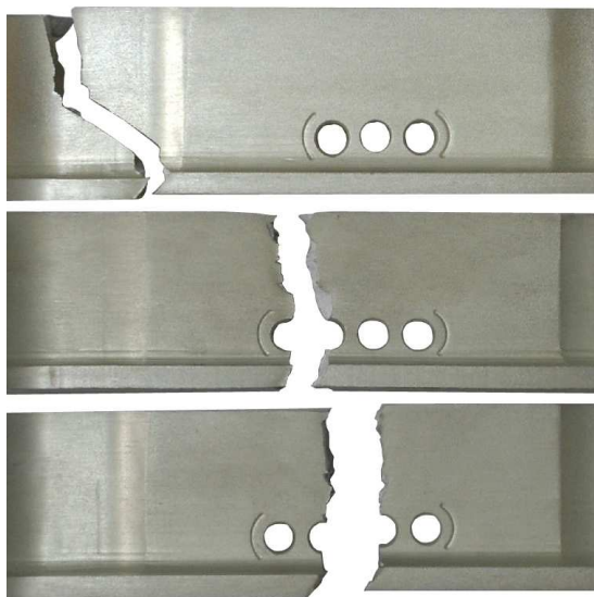
Рис. 13. Характер усталостного разрушения конструктивно-подобных образцов стрингеров с ОПТ (материал Д16Т), обработанных в зоне отверстий барьерным обжатием в виде лунок сегментной конфигурации на уровне нагружения: \sigma_{\text{бр min}} = -30 МПа,
