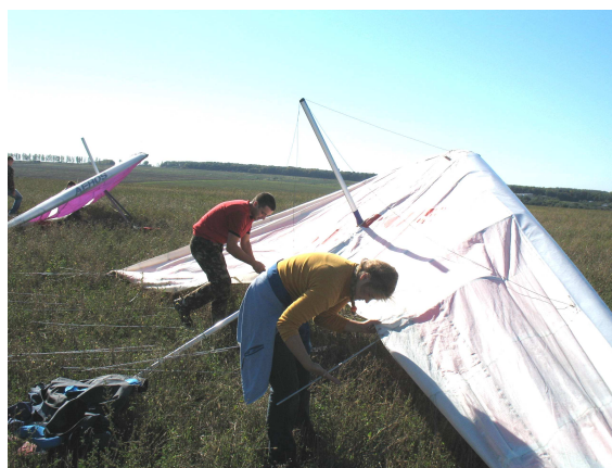
Рис. 1. Stealth-KhAI-2-14 установка профилезадающих элементов
