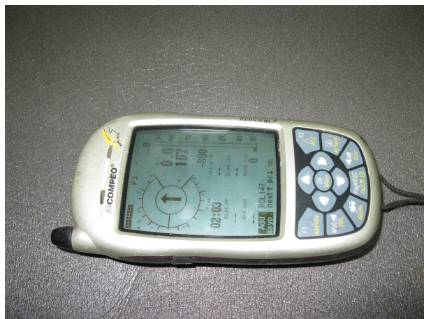
Рис. 3. Комбинированный прибор Brauniger Comreo+
