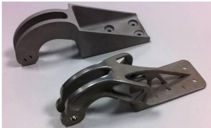
Рисунок 2.7 – Порівняння петель мотогондолі які виготовлені методом механічної обробки (зверху) і методом тривимірного друку(внизу)
