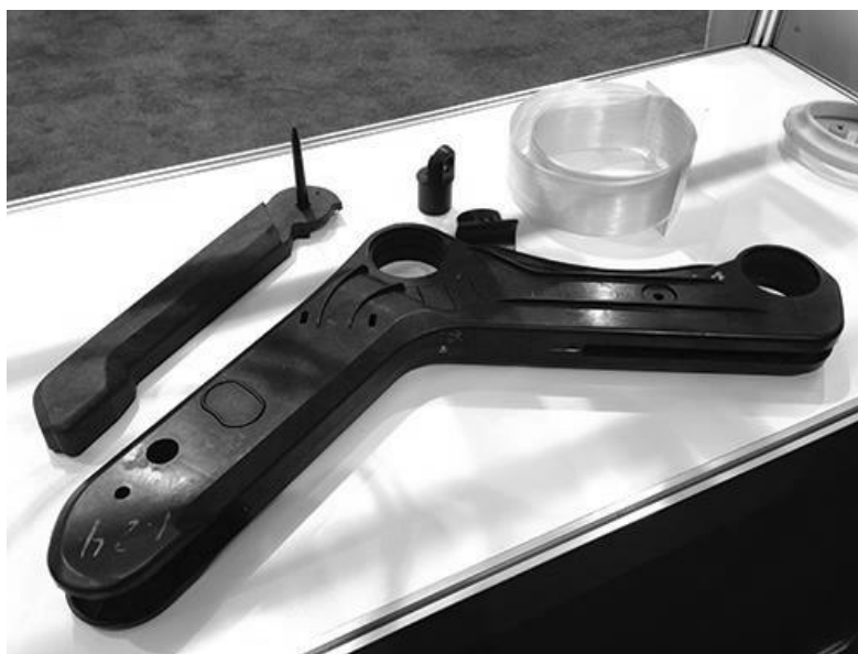
Рисунок 2.2 - Деталь пасажирського крісла, яка надрукована екструзійним методом
