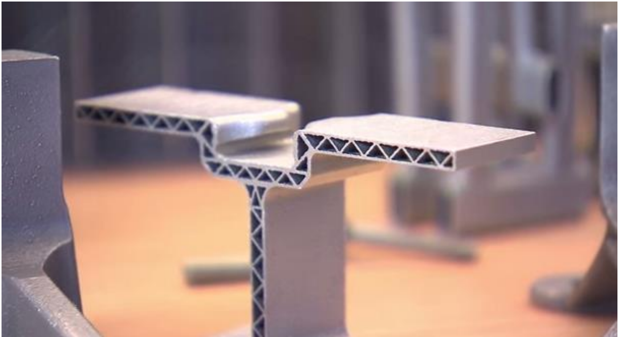
Рисунок 2.5 – Лонжерон, який виготовлений методом тривимірного друку
