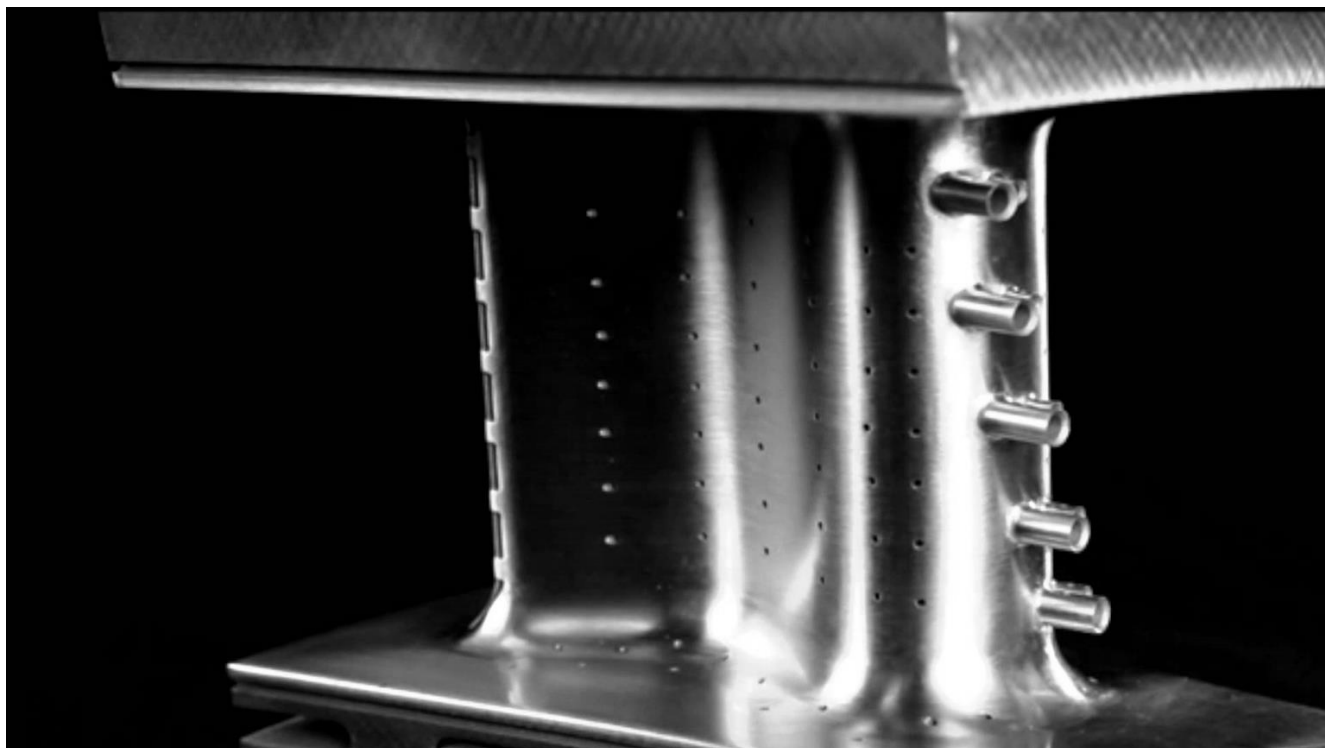
Рисунок 2.6 – Лопатка турбіни, яка виготовлена за допомогою тривимірного друку
