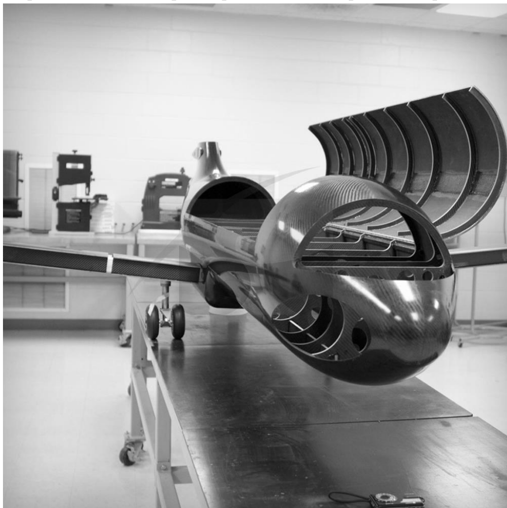
Рисунок 2.3 - Модель для аеродинамічних випробувань, метод полімеризації
