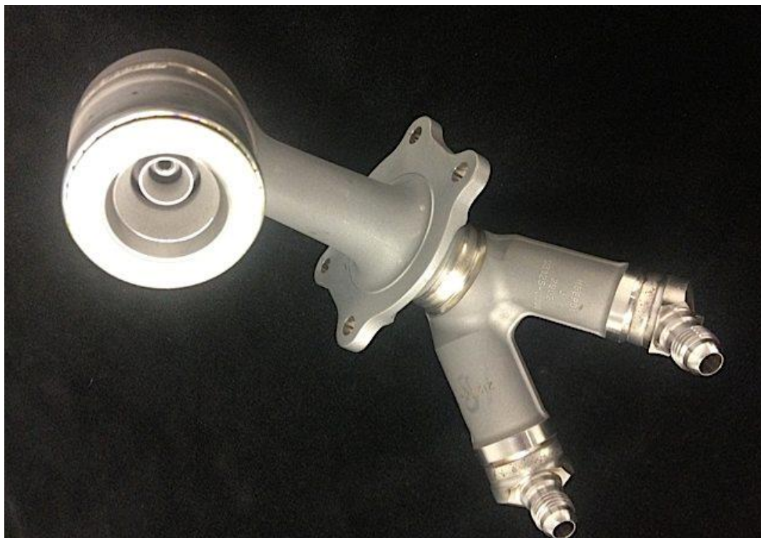
Рисунок 2.6 - Паливна форсунка, яка виготовлена за допомогою тривимірного друку
