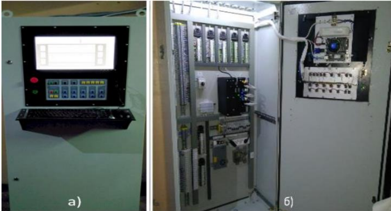
Рисунок 2.13 – Стійка управління комплексом термоімпульсної обробки: а) стійка системи ЧПК; б) внутрішній вигляд блоку управління
