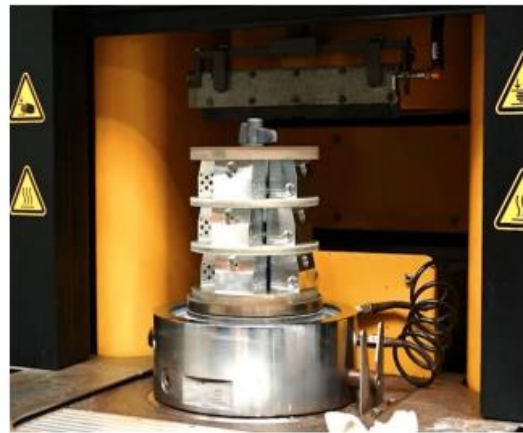
Рисунок 2.16 – Приклади розміщення деталей у робочій камері під час термоенергетичної обробки
