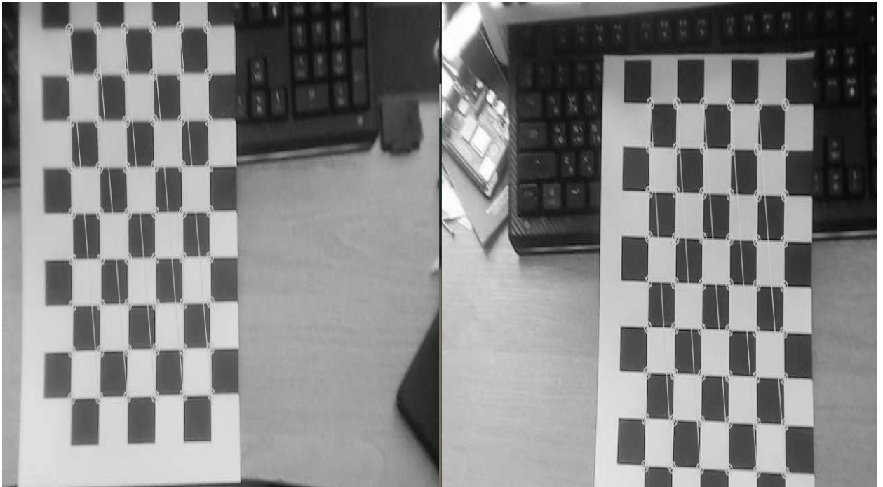
Рисунок 7.3 – Друга фотографія калібрування камери, повернутий на 45 градусів
