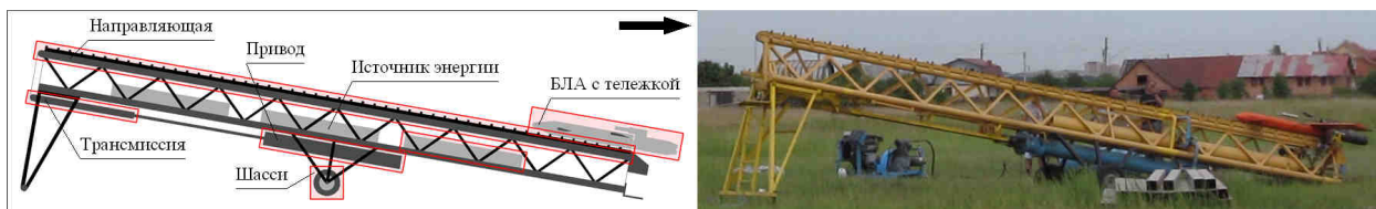
Рис. 1. Структура НПУ на примере катапульты Р12П с БЛА РМ130У
