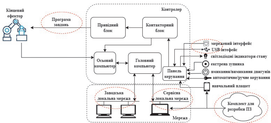
Рисунок 7.1 – Архітектура РТС (на прикладі робота)
