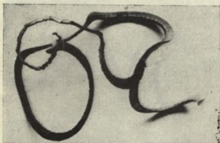
Рис. 2. а) Режим резания: t=1,25 мм; s=0,496 мм/об; v=31,5 м/мин. б) Режим резания: t=1,5 мм; s=0,496 мм/об; v=37,8 м/мин.
