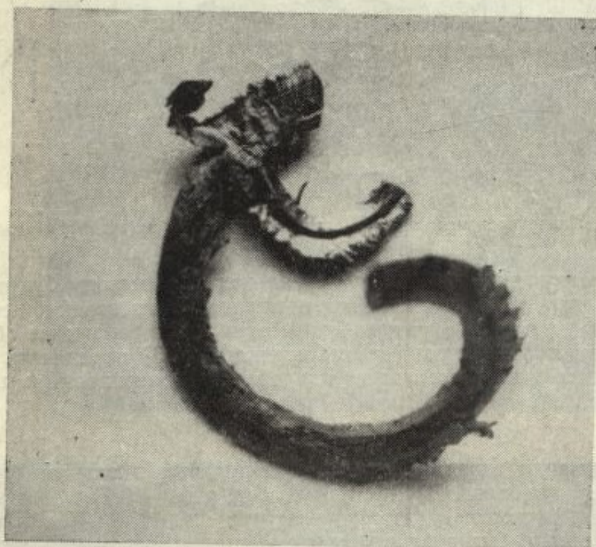
Рис. 2. д) Режим резания: t=1,25 мм; s=0,496 мм/об; v=22,5 м/мин.
