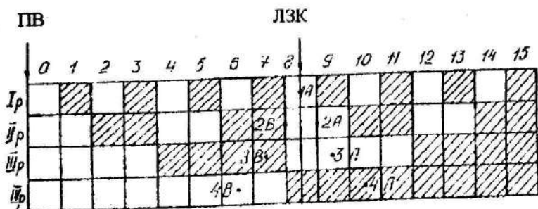
Рис. 1.12. Розгортка чотирирозрядної кодової маски з розміщенням чутливих елементів за методом Баркера
