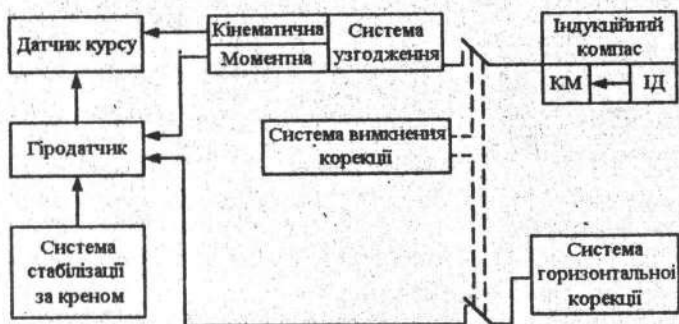
Рис. 3.15. Функціональна схема курсової системи у режимі магнітної корекції
