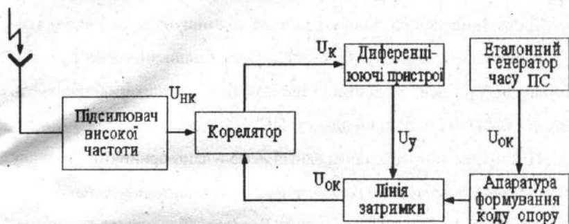
Рис. 7.5. Структурна схема апаратури ПС для визначення дальності
