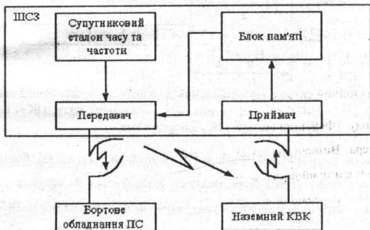
Рис. 7.3. Схема взаємодії системи "земля – супутник – повітряне судно"
