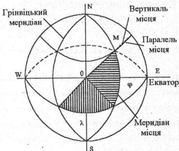
Рис. 3.1. Географічна система координат
