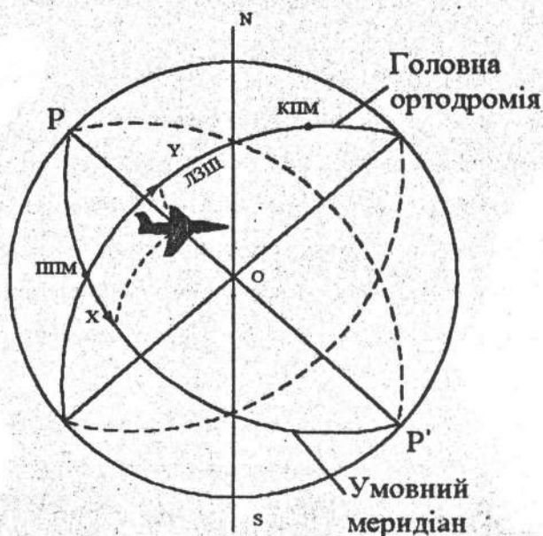
Рис. 3.2. Ортодромічна система координат: ППМ, КПМ – початковий та кінцевий пункти маршруту; ЛЗШ – лінія заданого шляху
