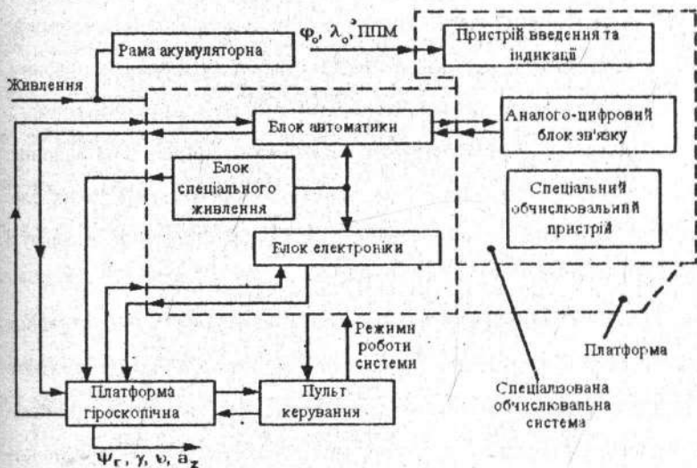
Рис. 3.26. Структурна схема інерційної системи І-ІІ-І
