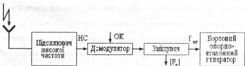
Рис. 7.6. Структурна схема апаратури ПС для визначення швидкості
