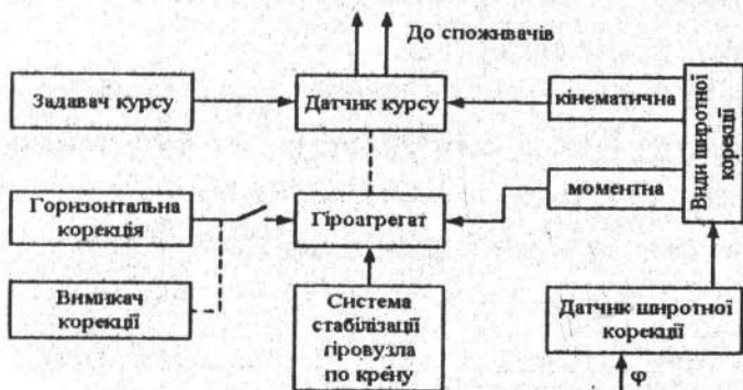
Рис. 3.10. Функціональна схема КС у режимі гіропівкомпаса
