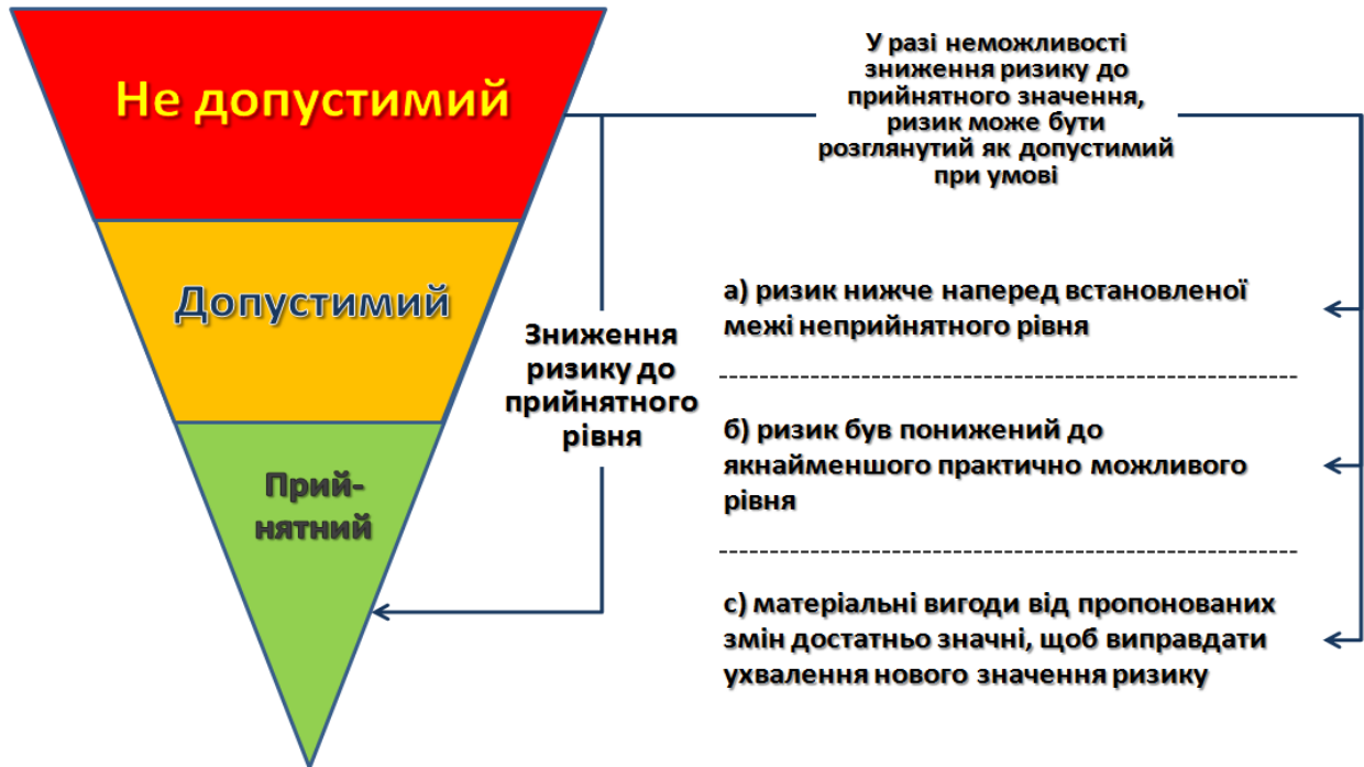
Рисунок 3.4 - Схема алгоритму дій у випадку неприйнятності ризику для безпеки польотів
