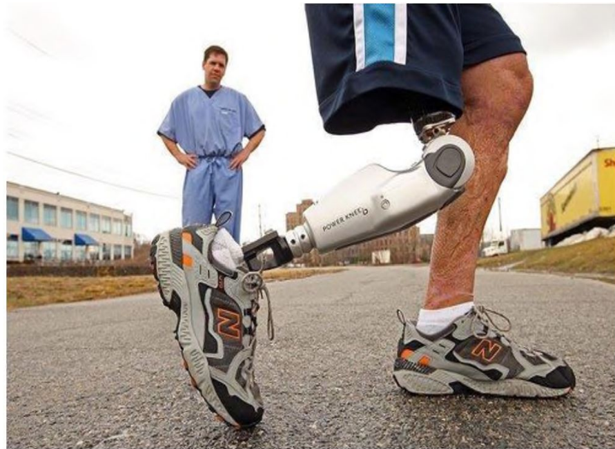
Рисунок 1.5 – Електронно - керований колінний модуль Power KNEE [9, 29]
