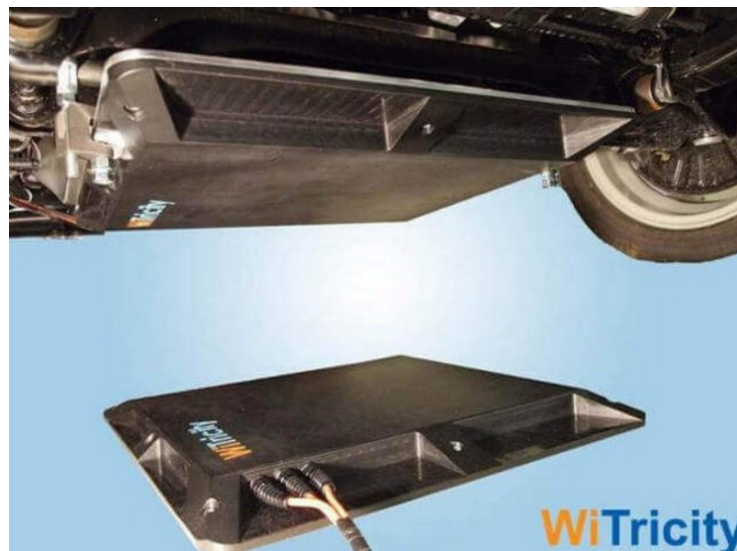
Рисунок 1.4 - Зображення взаємної орієнтації індукторів для ефективної зарядки електромобілів за технологією WiTricity [5]
