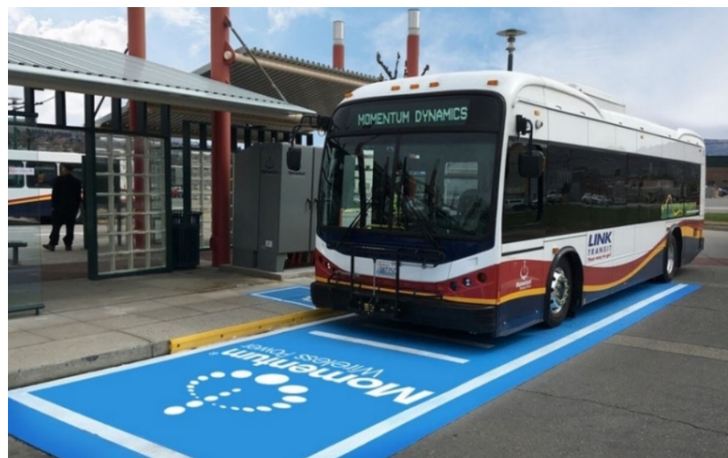
Рисунок 1.3 - Станція бездротової зарядки для електроавтобусів потужністю 200кВт, у США [4]
