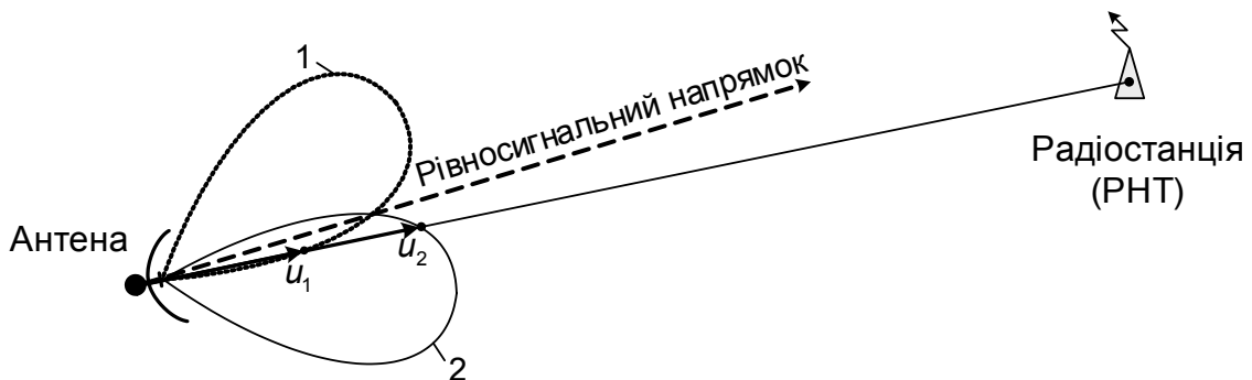
Рис. 3.18. Реалізація методу порівняння при переключенні однопелюсткової ДС антени
