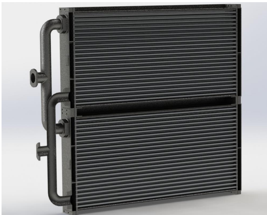
Рисунок 38 – Спрощена модель спроектованого газоохолоджувача (розріз по відвідному каналу)
