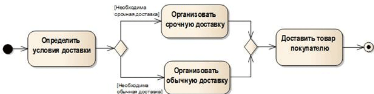
Рисунок Ж.2 – Приклад використання вузла рішення
