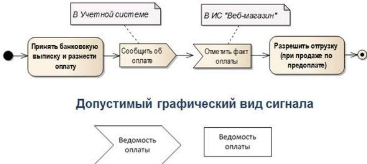
Рисунок Ж.4 – Приклад позначення передачі сигналу на діаграмі стану
