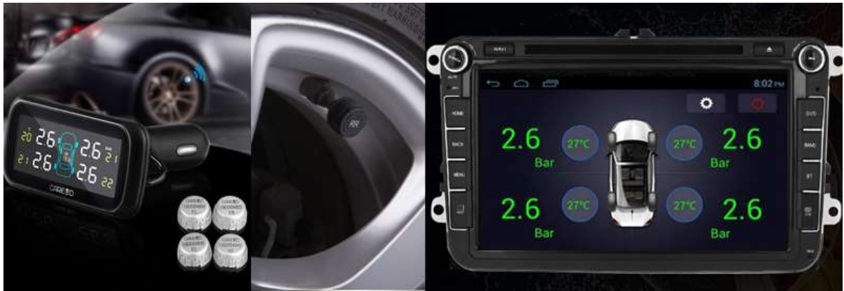
Рисунок 1.21 – Система контролю тиску повітря в шинах із зовнішніми датчиками [13]
