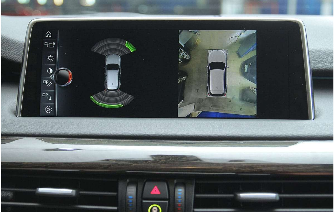
Рисунок 1.7 – Приклад роботи системи кругового огляду [23]
