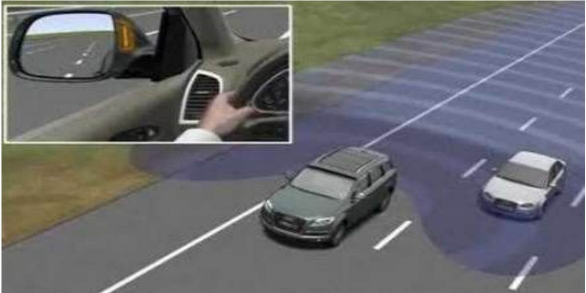
Рисунок 1.9 – Робота інтелектуальної системи Side Assist [19]
