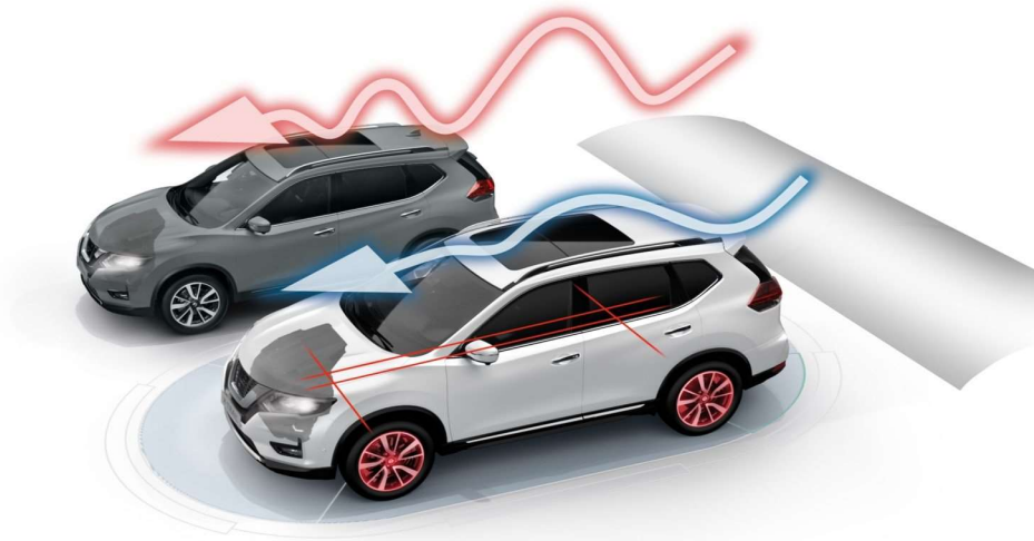
Рисунок 1.13 – Система інтелектуального управління плавністю ходу [23]
