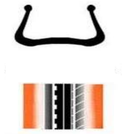
Рисунок 3.12 – Пляма контакту при недостатньому тиску в шині [8]
