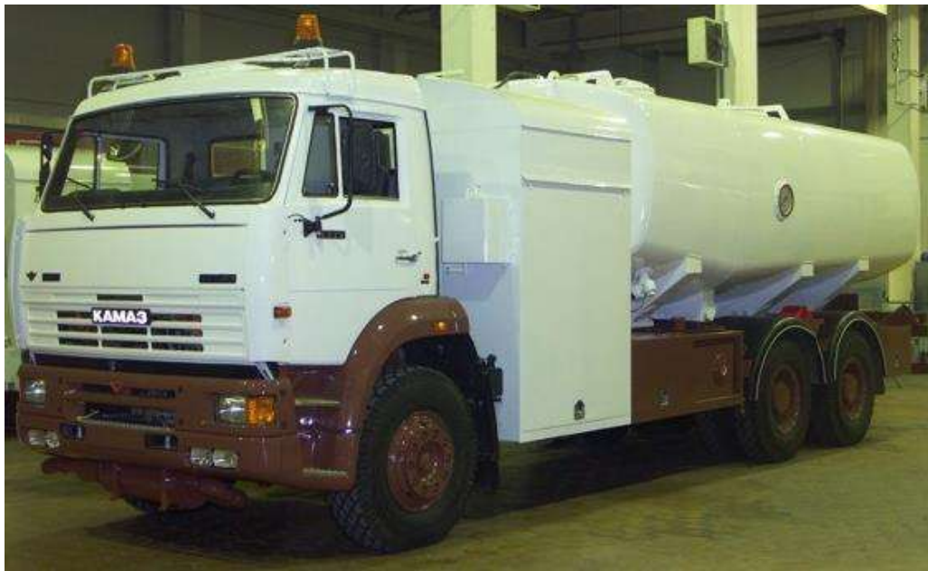
Рисунок 1.12 – Паливозаправник ТЗА-20-6520 на базі шасі КаМАЗ-6520
