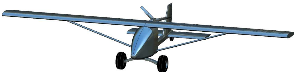
Рисунок 1.19 – Майстер-геометрія поверхні літака
