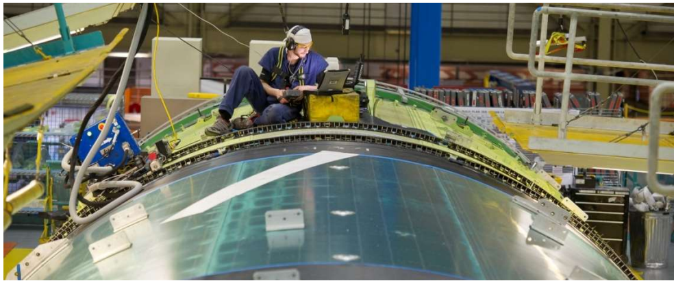
Рисунок 4.6 - Використання системи Flex Mini Track для свердління отворів стику відсіків фюзеляжу
