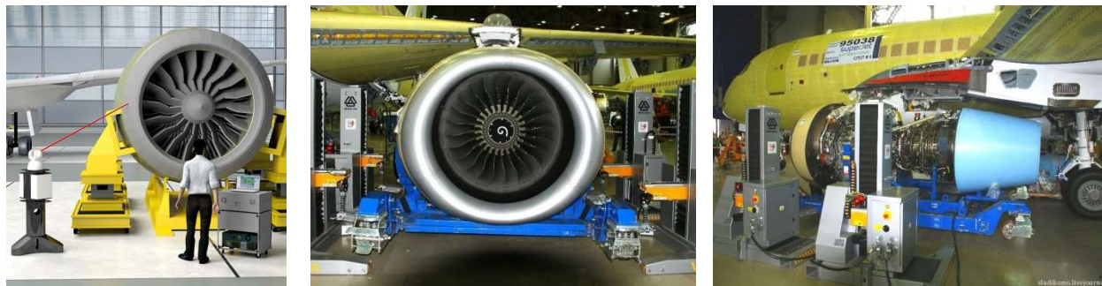
Рисунок 2.10 - Схема автоматичного монтажу мотогондולי і такелажно-базуючі вузли
