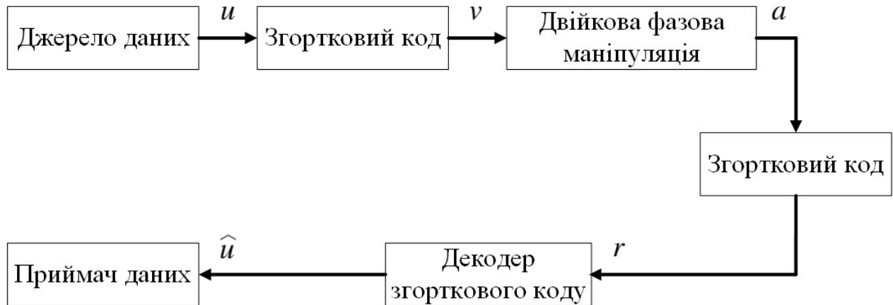
Рисунок 1.28 – Структурна схема системи передачі даних
