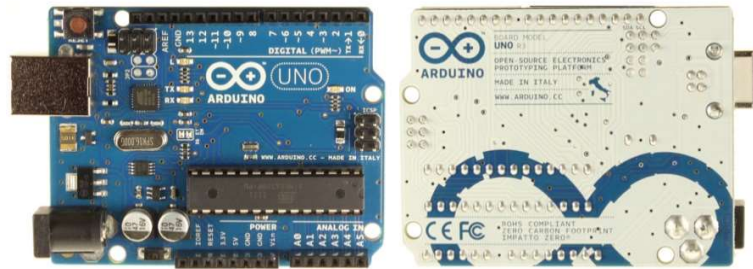
Рисунок 3.2 – Зовнішній вигляд Arduino UNO
