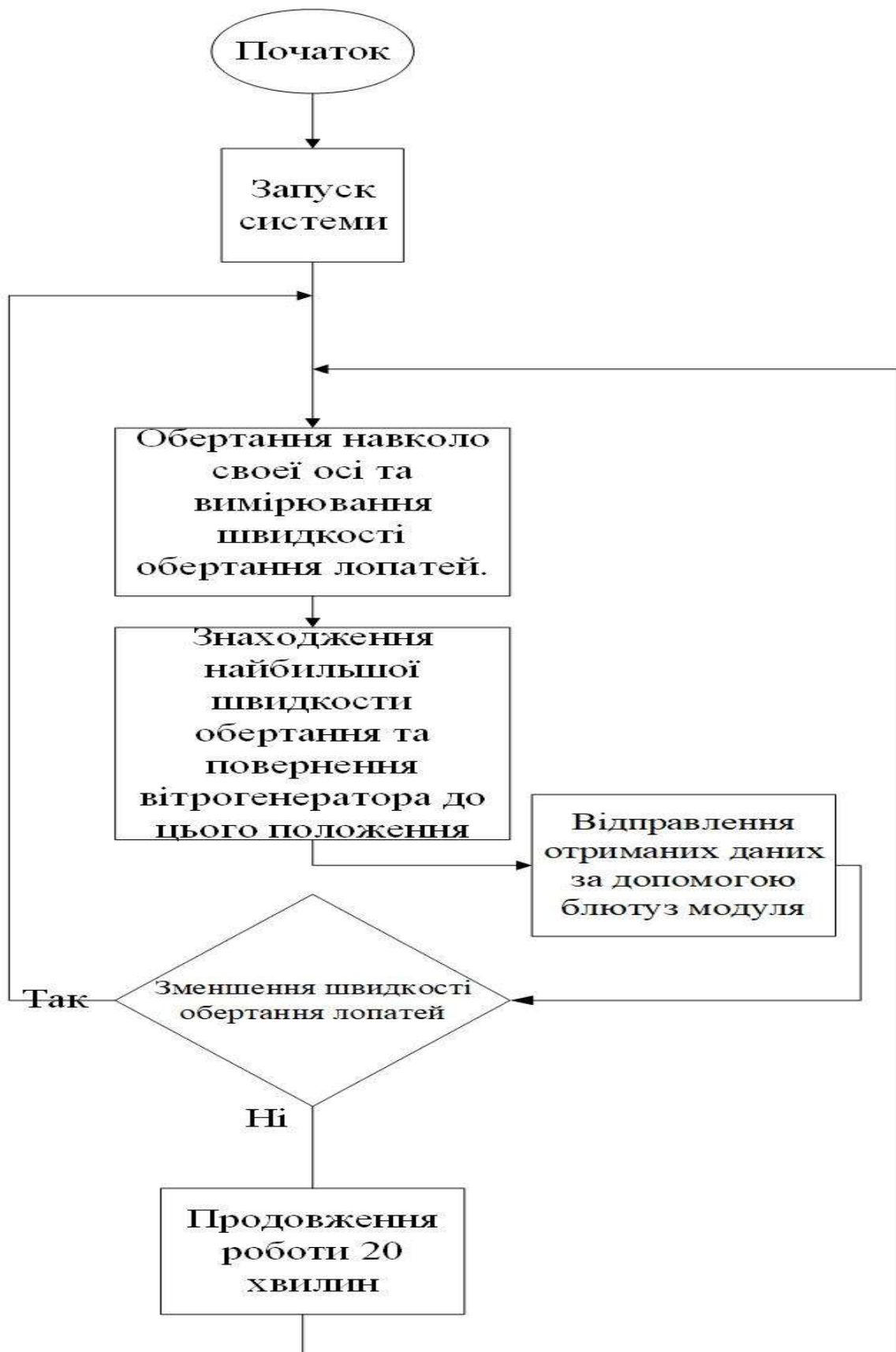
Рисунок 3.9 – Алгоритм роботи вітрогенератора
