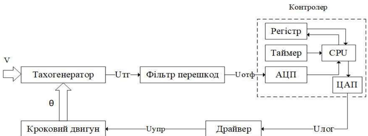
Рисунок 3.7 – Функціональна схема роторно–вітрової електроустановки
