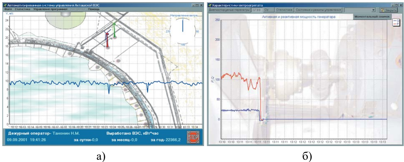
Рисунок 1.9 – Вікно відображення параметрів а) системи генерування ВЕУ і б) системи управління ВЕУ
