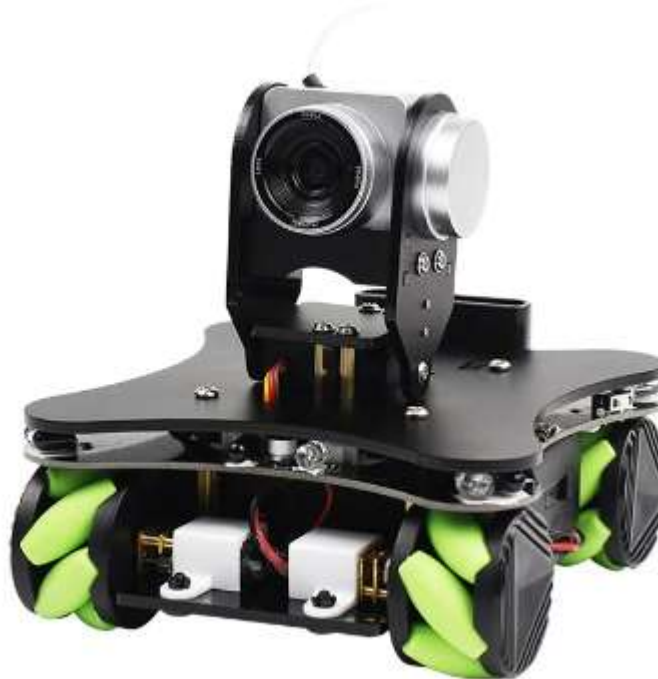
Рисунок 2.5 – Зовнішній вигляд робота з ОМНІ-колесами
