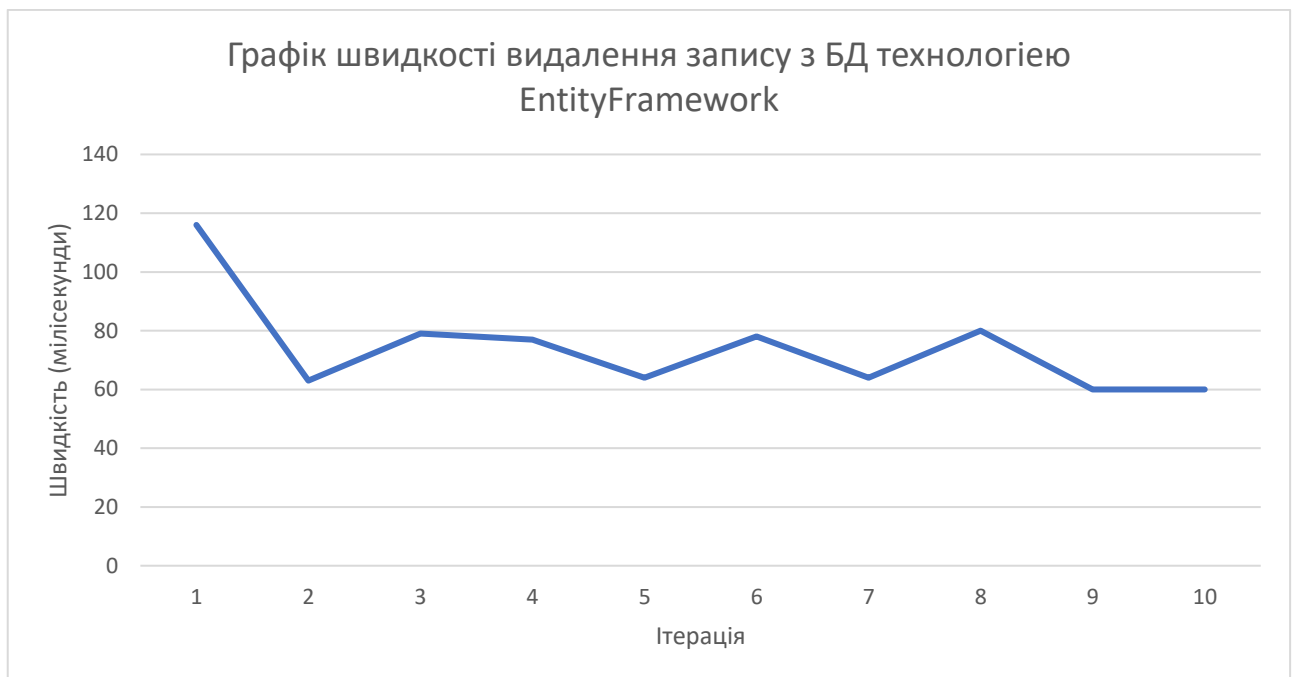
Рисунок 3.8 – графік швидкості видалення запису з БД технологією EntityFramework
