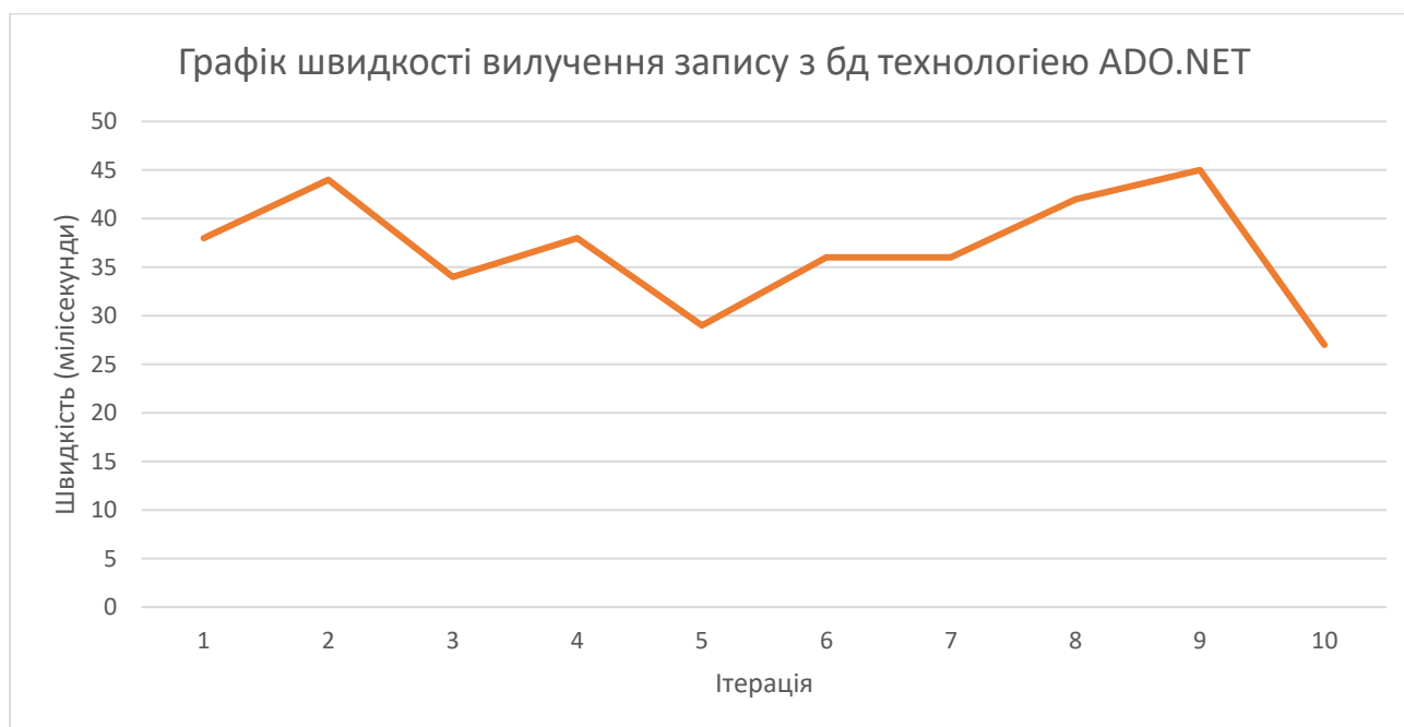
Рисунок0 3.18 – графік швидкості вилучення даних з БД технологією ADO.NET
