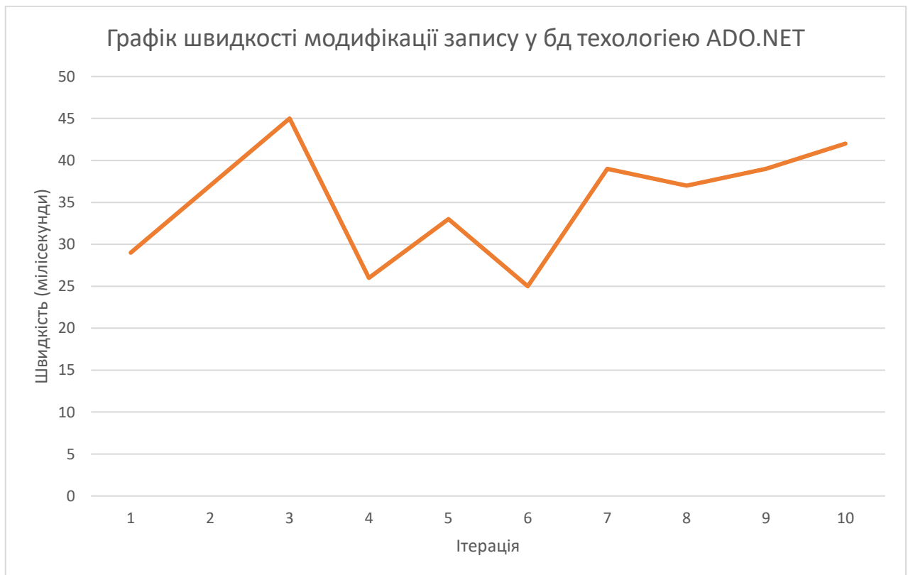
Рисунок 3.17 – графік швидкості модифікації запису у БД технологією ADO.NET
