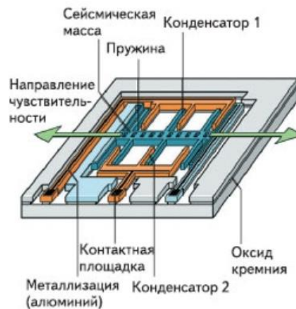
Рисунок 1.13 – Компоненти акселерометра для мобільних приладів
