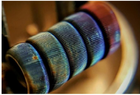
Рисунок 2.3 – Койл під струмом виготовленого з канталу.
